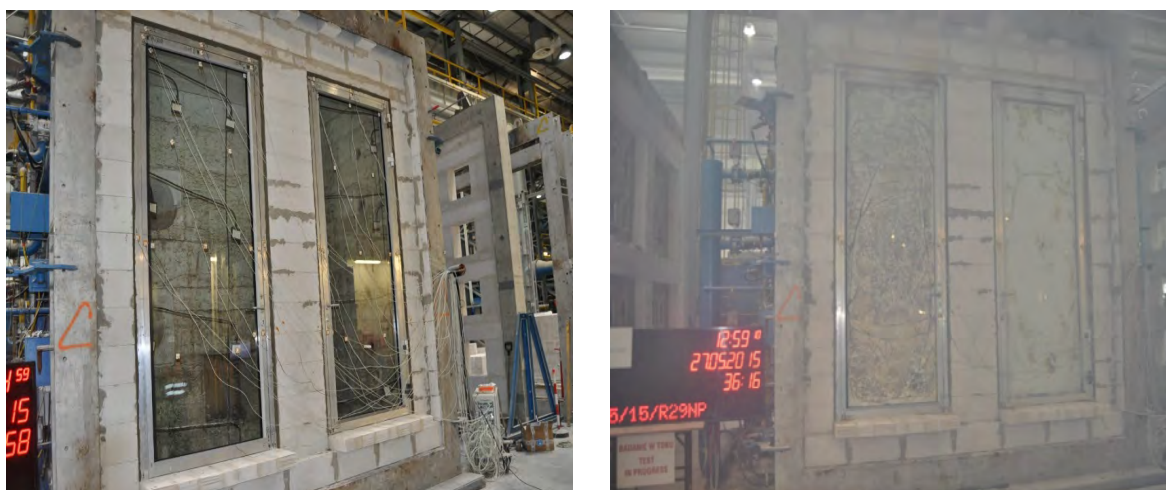
Rys. 1. Widok nienagrzewanej powierzchni aluminiowych profilowych drzwi jednoskrzydłowych (o wysokości > 3 m), o deklarowanej odporności ogniowej EI 1 30 przed i po badaniu w zakresie odporności ogniowej [źródło: archiwum ITB]
