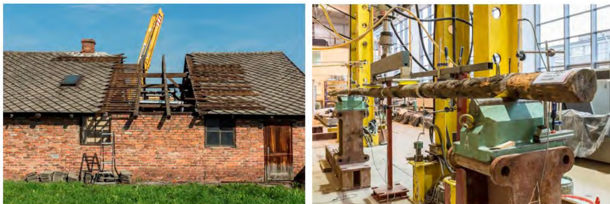
Rys. 5. Ilustracja nieniszczących badań reprezentatywnych krokwi pobranych z więźby w baraku nr 123
