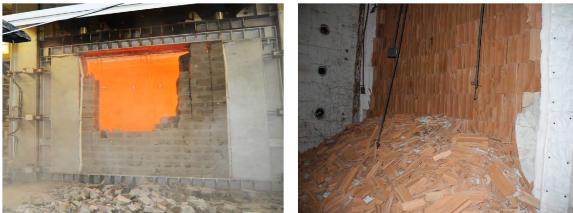
Rys. 7. Zniszczenie ściany z pustaków o dużych drażeniach podczas badania odporności ogniowej (obliczeniowo REI 240, weryfikacja badawcza REI 45), z lewej; sposób „łuszczenia” kolejnych warstw pustaków o dużej ilości małych drażeń, widok po badaniu [źródło: archiwum ITB]
