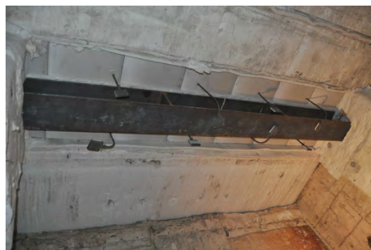
Rys. 4. Schemat statyczny badanej belki stalowej oraz widok elementu próbnego przed badaniem, [źródło: archiwum ITB]
