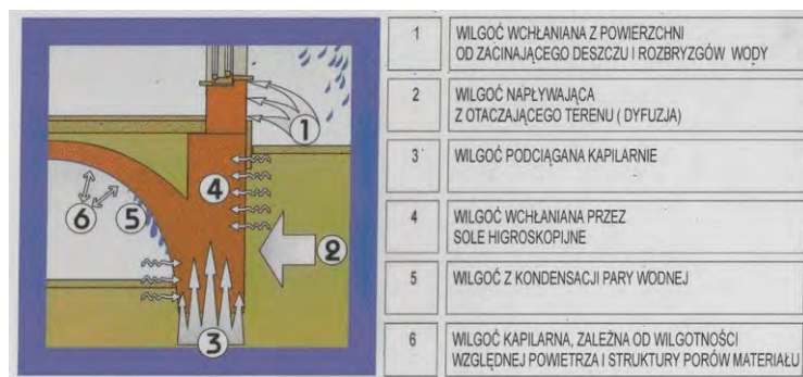
Rys. 3. Mechanizmy napływu wilgoci
