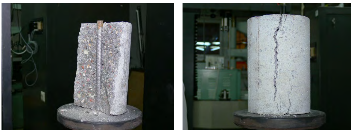
Rys. 6. Sposób zniszczenia próbki betonowej podczas wyrywania przęta f10 z betonu C25/30 w warunkach normalnych 20°C (z lewej) oraz po nagrzaniu do temperatury 700°C i ostudzeniu do 20°C, [źródło: opracowanie własne]
